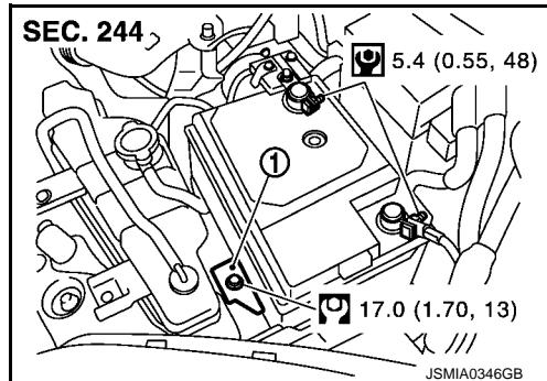
适用于免保养蓄电池车型：拆卸和安装
