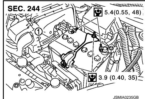
适用于需保养蓄电池车型：拆卸和安装
